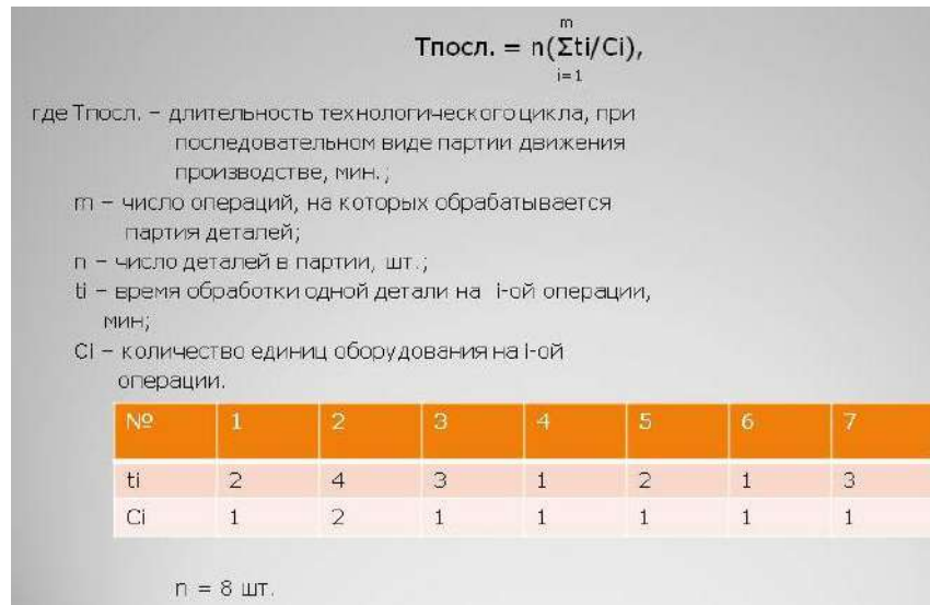
Рис.1. Длительность технологического цикла при последовательном виде движения Ниже приведен пример (рис.2) построения графика технологического цикла при последовательном движении деталей по операциям для следующих данных:
