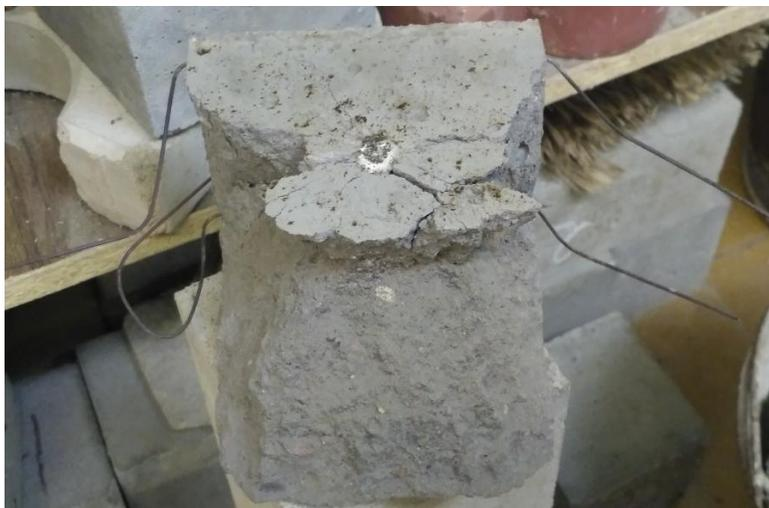
Рисунок 2. Образец со стеклопластиковой арматурой
