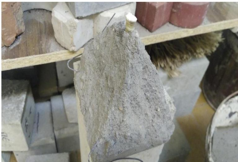
Рисунок 1. Образец со стеклопластиковой арматурой
