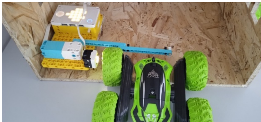
Рис. 3. Датчик цвета воспринимает сигнал от объекта
