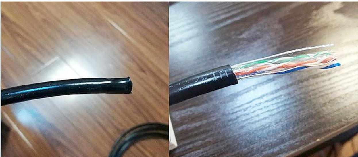
2. Раскрутить все пары проводов, расположить их в нужном порядке (в соответствии со схемой обжима). После выпрямить провода, не нарушив раскладку проводов, и обрезать провода по одной линии (выступ проводов от основного защитного кожуха пример- но 1—1,3 см).
