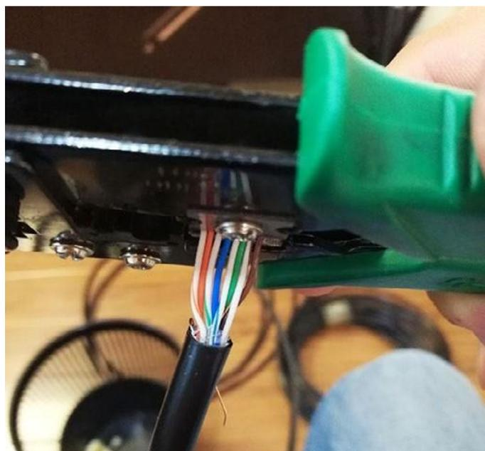
3. Установить провода в коннектор так, чтобы все провода полностью входили в коннектор. Ещё раз проверить по цветам, правильно ли располагаются провода в коннекторе.
