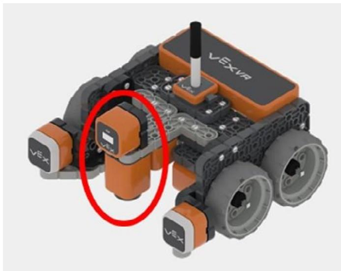
Рис. 30. Датчики цвета на VR-роботе
