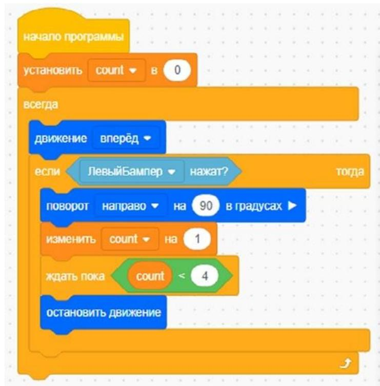
Рис. 19. Обход VR-роботом периметра игрового поля с использованием датчика касания
