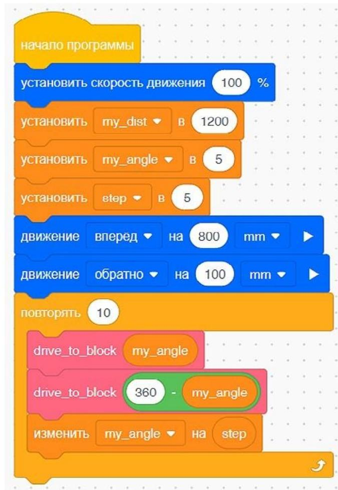
Рис. 75. Пример итоговой программы для прохождения VR-роботом испытания
