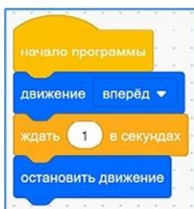
Рис. 42. Пример программы с использованием блока **Ожидания**
