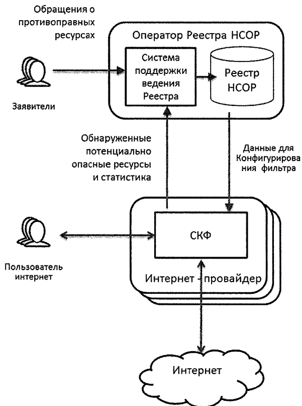
Рисунок 6. Принцип контроля доступа через Реестр НСОР
